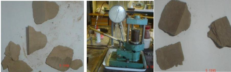
شكل ٨- قوة الكسر للمكعبات الطينية المثبتة بالإسمنت باستخدام الجهاز الهيدروليكي الصغير كون المكعبات ذات مقاس 30x30x30 مم.
